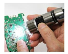
Le AM5018MZT est le modèle idéal pour effectuer des observations en temps réel et ne nécessitant aucune prise de mesure ou de cote. Connectez le AM5018MZT directement à un écran HD par le biais d'une connexion DVI, et profitez de la haute définition pour déceler les défauts de surface pour vousmême et tous vos collaborateurs. Modèle polarisé. Traité anti ESD.
