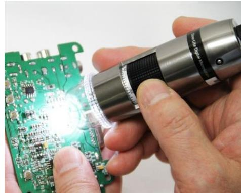
Le AM5018MZTL est le modèle idéal pour effectuer des observations en temps réel et ne nécessitant aucune prise de mesure ou de cote. Connectez le AM5018MZTL directement à un écran HD par le biais d'une connexion DVI, et profitez de la haute définition pour déceler les défauts de surface pour vous-même et tous vos collaborateurs. **Modèle longue distance de travail**, polarisé. Traité anti ESD.
