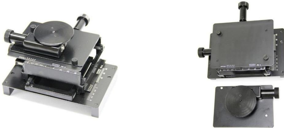
La table MS15X est une solution de support permettant de déplacer l'échantillon en X/Y tout en contrôle, notamment en cas de très fort grossissement : l'utilisateur ne perd ainsi pas ses repères. Modèle équipé d'un plateau rotatif amovible et de pinces pour une fixation au plateau des potences MS35B/MS36B/MS36BE.
